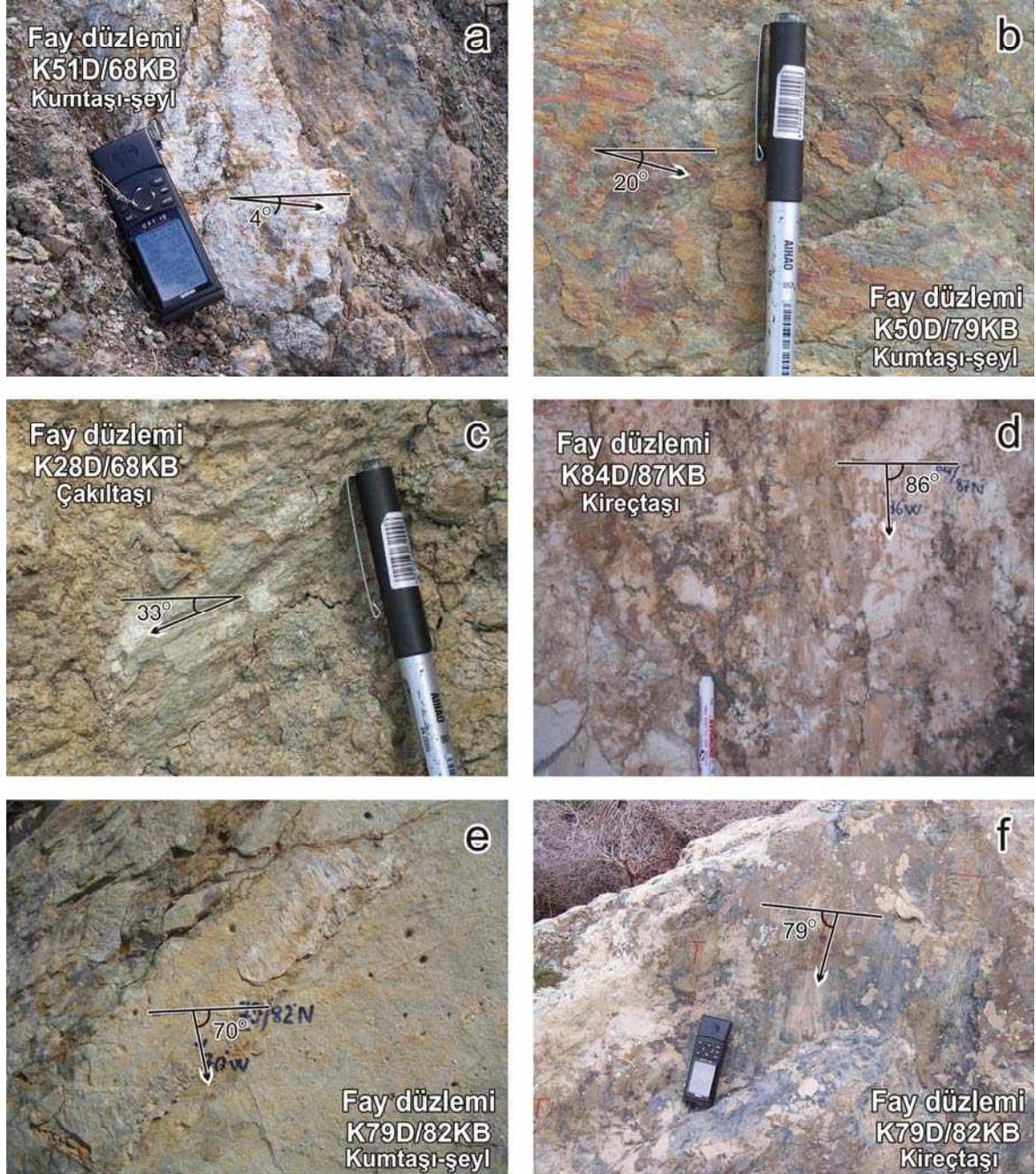
Şekil 4. (a-c) Seferihisar Fayına ait yataya yakın fay çizikleri içeren fay düzlemleri, (d-f) İzmir Fayına ait eğim atımlı faylanmayı belirten fay düzlemleri.
